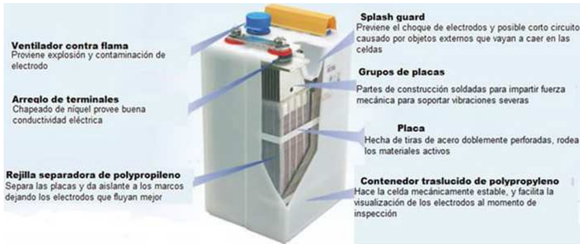
Ilustración 2: Componentes básicos de una celda de Níquel-Cadmio.
