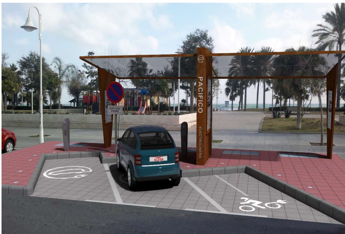
Um modelo de estação de carga angular com pontos duplos e carga independente para motos e com copa fotovoltaica associada. Fonte: ACTISA
