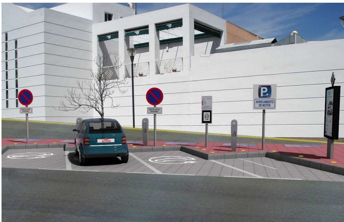
Modelo de estação de carregamento angular com pontos duplos e carregamento independente para motos. Fonte: ACTISA
